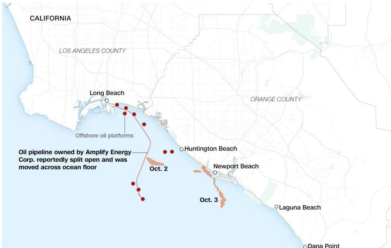
**FIGURE 1. LEAK LOCATION**
